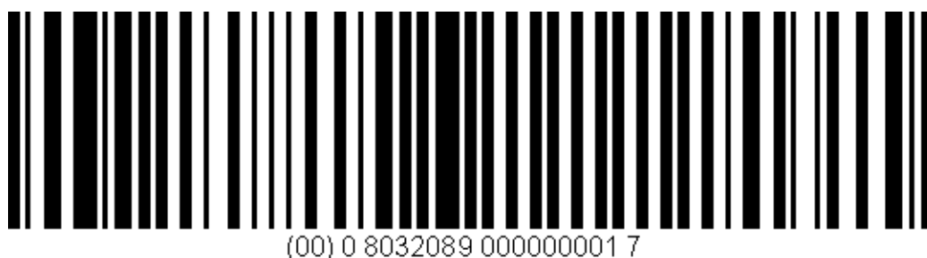
Figura 2-1: Esempio di simbolo GS1-128, contenente un codice SSCC
