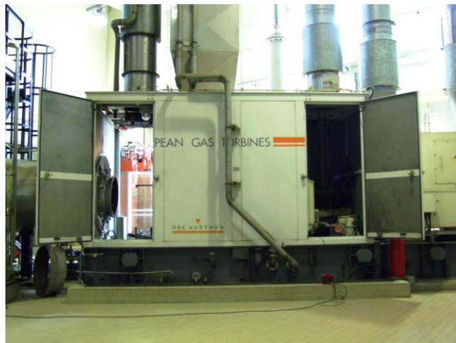
Foto 2.2 : Vista complessiva cabina insonorizzata di macchina
