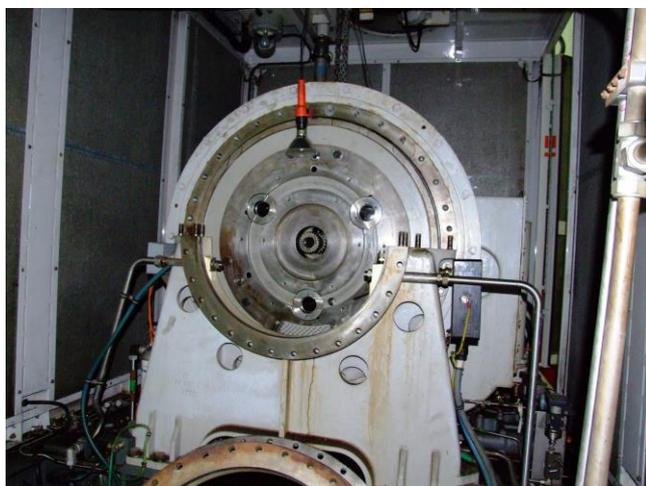
Foto 2.5 : Particolare “flangia” di connessione alternatore – asse di macchina
